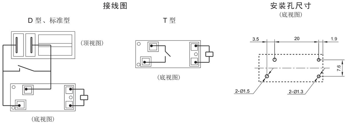
备注: (1) 产品部分外形尺寸未注尺寸公差, 当外形尺寸 $\leq 1\text{mm}$ , 公差为 $\pm 0.2\text{mm}$ ; 当外形尺寸在 $(1 \sim 5)\text{mm}$ 之间时, 公差为 $\pm 0.3\text{mm}$ ; 当外形尺寸 $> 5\text{mm}$ , 公差为 $\pm 0.4\text{mm}$ ;
