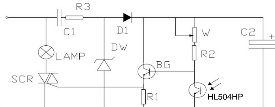
上图为光控路灯电路，白天路灯熄灭，夜间路灯自动点亮。图中，电容 C1、C2、R3 和二极管 D1 及稳压管 DW，组成简单的电容降压整流电路，接通电源后获得 12V 左右的直流电压。三极管 BG、环境光探测器 PT850F5C 和双向可控硅等，组成光电开关电路。
