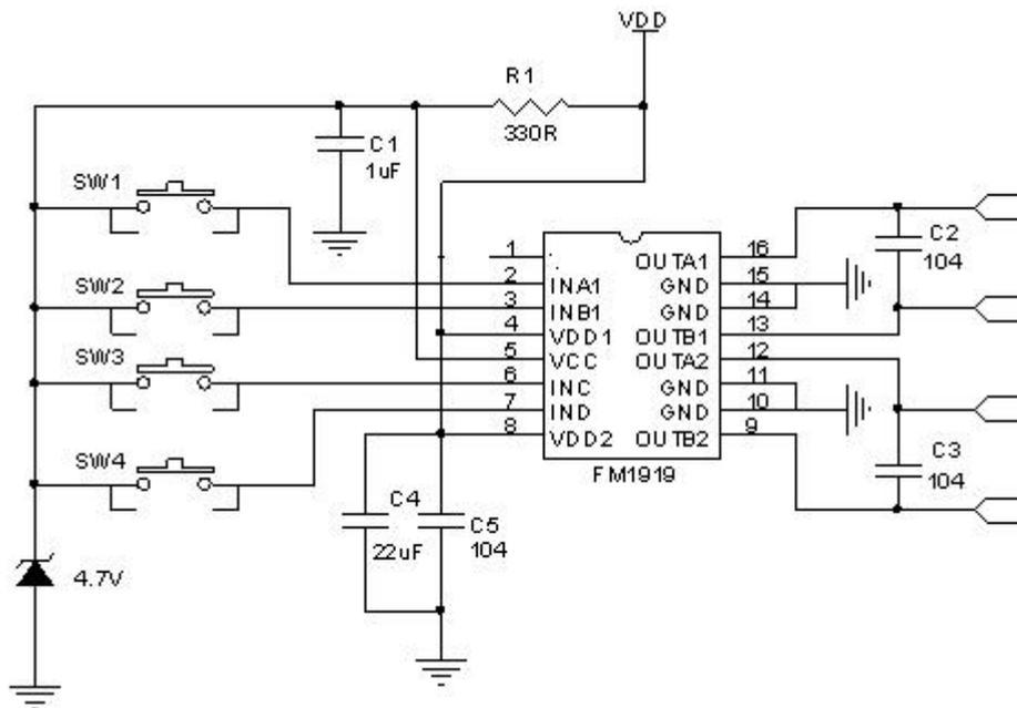
注：图中 C2、C3（100nF）电容为置于 PCB 板上，可视所使用的马达干扰程度来使用或省去，当然并接于马达上的那颗插件 104 不能省。在不同的应用中，C4、C5 可考虑只装一个：在 3V 应用中建议用一个 1uF 或以上；在 4.5V 应用中建议用一个 4.7uF 或以上；在 6V 应用中建议用一个 10uF 或以上；在 9V 应用中建议用 22uF 或以上。均为使用贴片电容靠近 IC 之 VDD 管脚放置且电容的负极和 IC 的 GND 端之间的连线也需尽量短。即不要电容虽然近，但布线、走线却绕得很远。VDD1 和 VDD2 连线尽量短，若非如此 VDD 应有各自的电容。另外当使用大电解插件电容时，建议再并一个 100nF 于 VDD 脚上。
