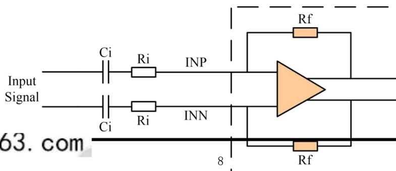
增益确定，也就是输入阻抗确定了之后，输入隔直电容 $C_i$ 的选取尤为重要。一方面，电容值直接影响放大器的低频特性；另一方面，开关机 POP 声的抑制性能受电容的影响，如果耦合电容大，则反馈网络的延迟大，pop 声容易出现，相反较小的耦合电容可以减少该噪声。因此，输入电容  $C_i$  的选取要兼顾这两个方面。比如，增益为 20dB，总输入阻抗为 30k，-3dB 转折点  $f_c$  取 53Hz，由上计算公式得  $C_i=0.1\mu\text{F}$ 。
