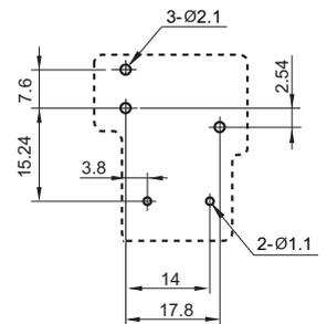
备注: (1) 产品部分外形尺寸未注尺寸公差, 当外形尺寸 $\leq 1\text{mm}$ , 公差为 $\pm 0.2\text{mm}$ ; 当外形尺寸在 $(1 \sim 5)\text{mm}$ 之间时, 公差为 $\pm 0.3\text{mm}$ ; 当外形尺寸 $> 5\text{mm}$ , 公差为 $\pm 0.4\text{mm}$ ;
