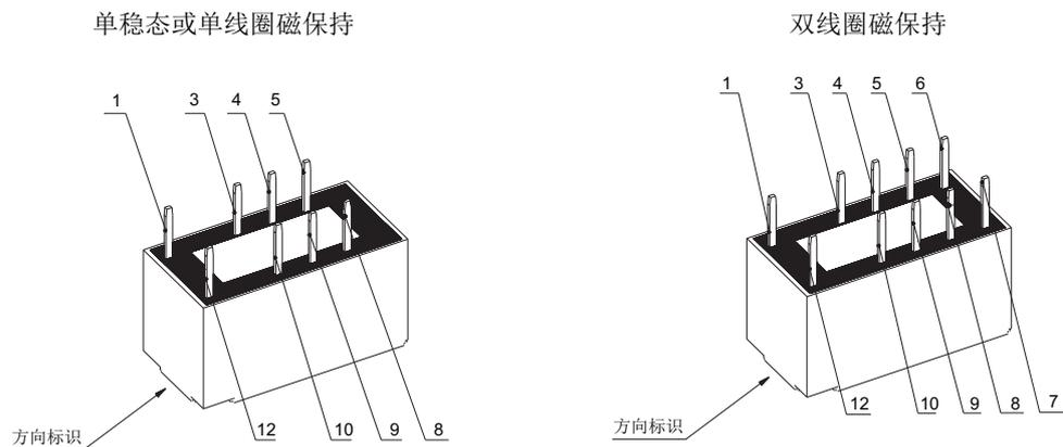
备注: (1) 产品外形图的引脚标注尺寸为沾锡前尺寸(沾锡后会变大), 安装孔尺寸为推荐的PCB板孔的设计尺寸, 具体PCB板孔设计尺寸可根据产品实物进行测绘、调整;
