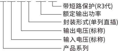
1W, 定电压输入, 隔离非稳压单路输出
