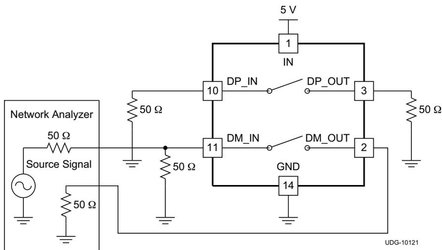
图 35. OFF State Isolation ( $O_{IRR}$ )
